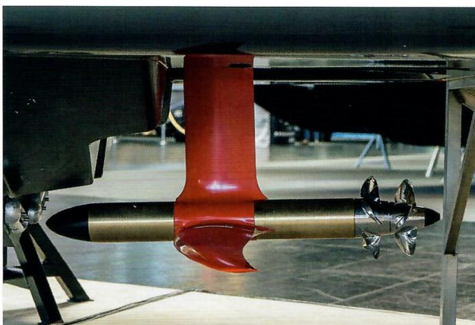
Die beiden Elektromotoren sind in einer torpedoförmigen Gondel untergebracht und treiben zwei gegenläufige Propeller an. An dieser Gondel ist auch das Heckfoil montiert.
