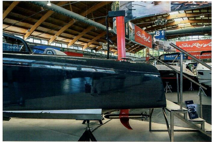
Auch der Pod-Antrieb mit dem Heckfoil lässt sich für seichtes Wasser oder zum Trailern hochfahren.
