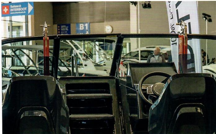
In hochgefahrenem Zustand ragen die Masten des Foils ins Cockpit.
